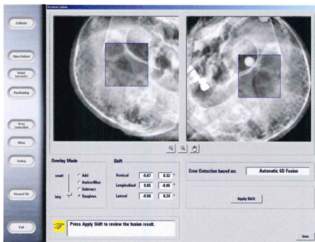
図2 ノバリス Tx に搭載される ExacTrac X-ray の表示画面 治療計画の DRR 像と ExacTrac X-ray 画像を自動照合し、高精度なセッティングを担保する
