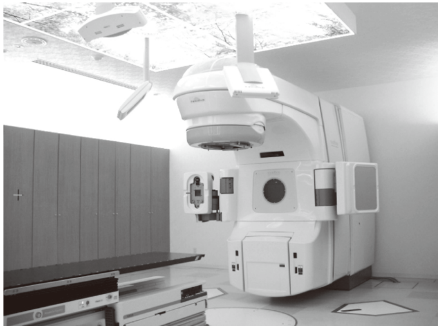
図1 最新の高精度放射線治療装置ノバリスTx 精細で鮮鋭なビーム形成、最高水準の高出力などの高機能と最先端の画像誘導技術(IGRT)により、定位放射線治療とIMRTを簡便かつ高精度に実施できる。
